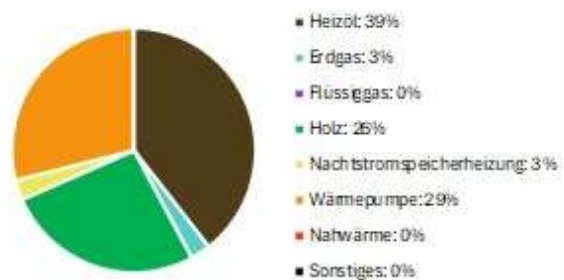
Anteil Primärenergieträger an Gebäuden
